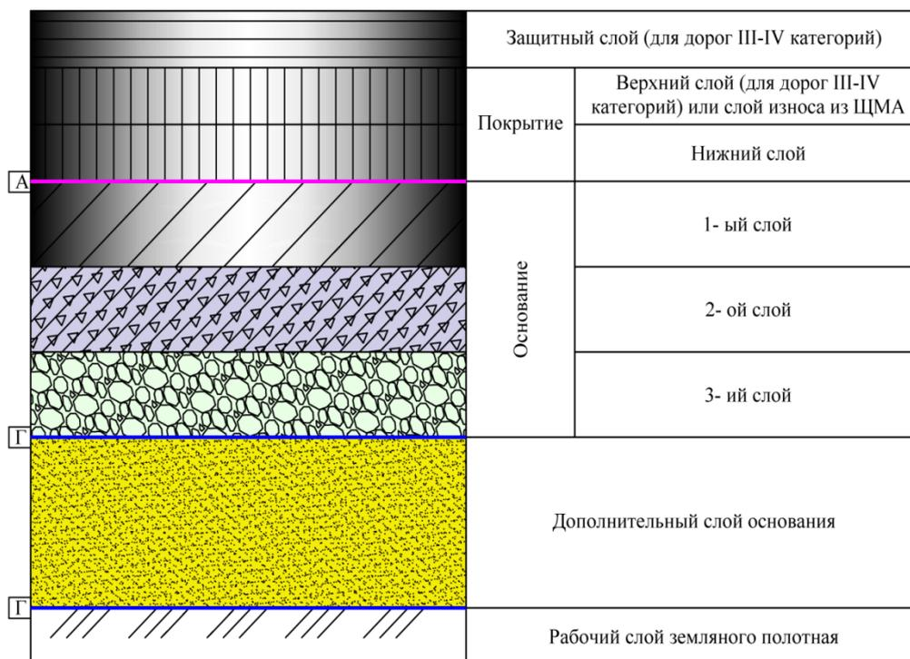
Рисунок – Конструкция дорожной одежды:
