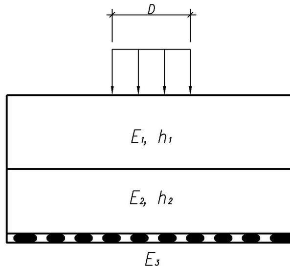
Рис. 6.2 Расчетная схема дорожной одежды капитального и облегченного типов, армированной георешеткой
