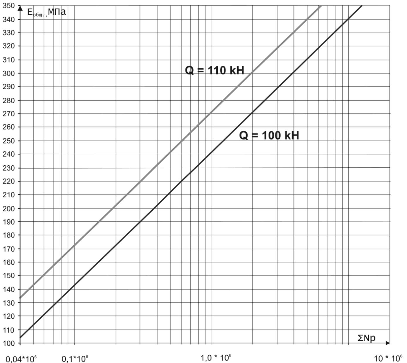
Рис. 6.4 – Зависимость общего расчетного модуля упругости конструкции  $\hat{A}_{i\hat{a}i}$  от суммарного расчетного числа приложений нагрузки за расчетный срок службы  $\sum N_p$ ,  $Q$  – нормативная статическая нагрузка на ось расчетного автомобиля (к п. 6.2.8)
